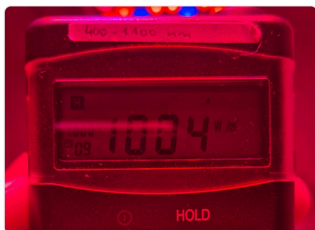
Solarmeter TES 1333 bei 30 cm: 1.004 W/m 2 .
