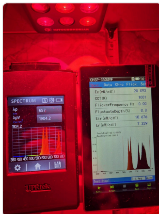
OHSP-350UVF · UPRtek CV600 bei 5 cm.
